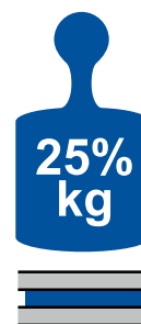
Montage horizontal = 25% de la charge mentionnée
