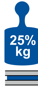
Horizontal montiert = 25% genannter Lastwert
