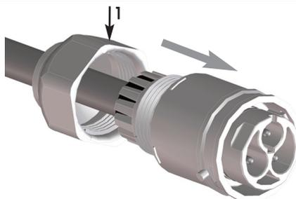
Avvitare il dado (1) al corpo (3) in modo da bloccare il cavo e stringere la guarnizione. Il dado (1) va girato con una chiave (coppia di serraggio 2.5 Nm) tenendo ben fermo il corpo (3).
