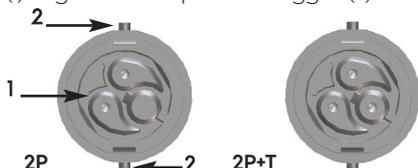
3701/V...: corpo spina (1) + guscio con pin di fissaggio (2) e bloccacavo
