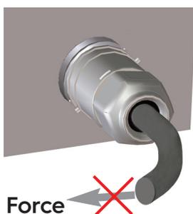
**N.B.:** il raggio di curvatura del cavo di alimentazione deve essere almeno 4 volte il valore del diametro del cavo.
