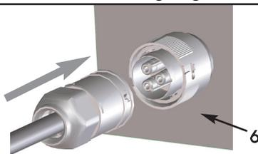
Ruotare completamente la ghiera "7" in modo che i fermi "8" posti sul corpo del connettore entrino perfettamente nelle aperture poste sulla ghiera "7".
